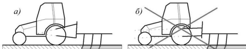
**Рисунок 6.5.3 – Агрегатирование культиватора на 3<sup>х</sup> точечную сцепку трактора**
