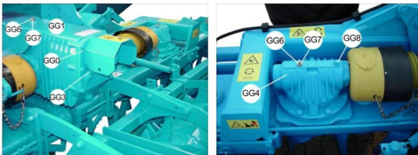
**Рисунок 8.1.12 – Замена масла в промежуточной передаче и в боковых угловых передачах**
