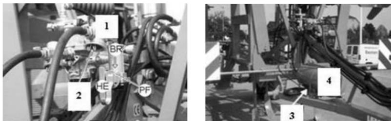
1 – очищающие фильтры; 2 – фиксирующая скоба; 3 – клапан для слива воды; 4 – бачок
