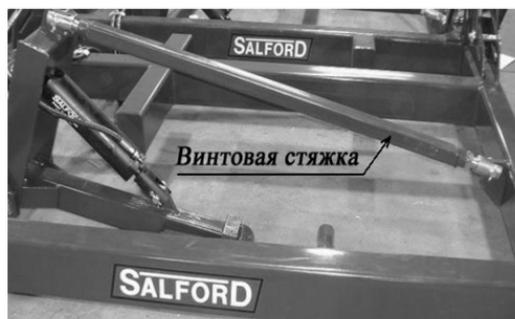
**Рисунок 7.6.5 – Выравнивание рамы по ширине**
