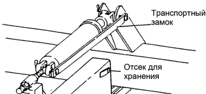
**Рисунок 4.2.7 – Транспортный замок в закрытом положении**
