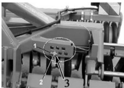
**Рисунок 7.4.4 – Регулировка смещения рядов сферических дисков**
